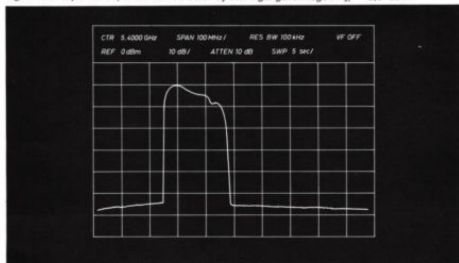
Fig. 6. De frequentieresponsie van de deler bij een ingangsvermogen P_m = 3,0 \text{ dBm} .
