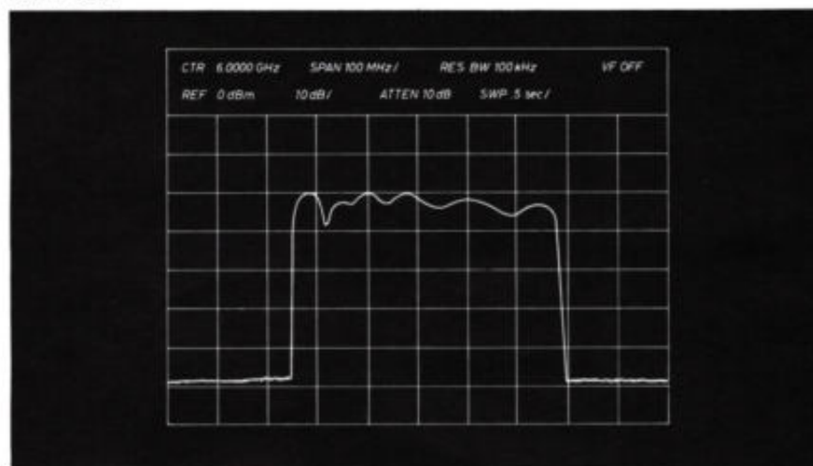
Fig. 9. De frequentieresponsie van de monolithische frequentiedeler bij een ingangsvermogen van 17 dBm.
