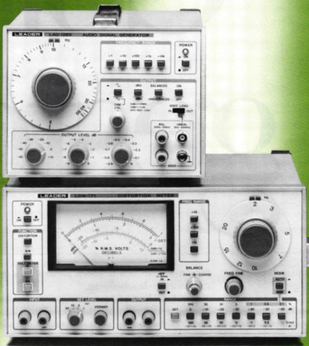
Afgebeeld: LAG 126S: audio generator 5Hz - 500 KHz, vervorming 0,005%. LDM 171 : vervormingsmeter 20 Hz - 20 KHz.
